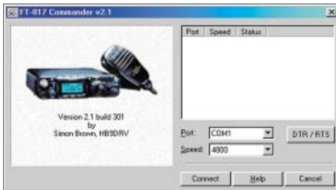
Bild 1: Im Startfenster erfolgt als erstes die Abfrage des COM-Ports und der Übertragungsgeschwindigkeit. Bei unterlassener Eingabe sucht das Programm auch selbständig danach.
