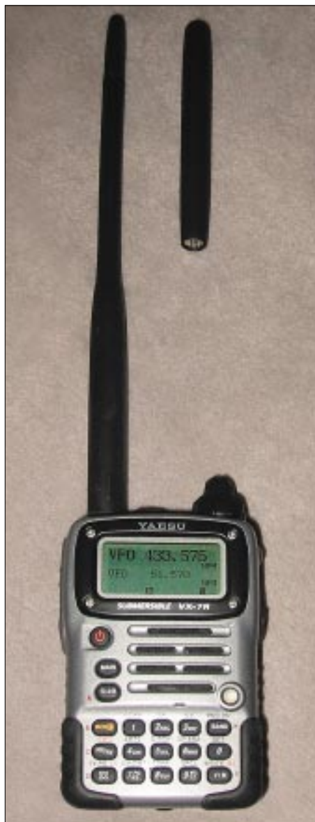
Bild 3: Stabile und solide Gummiantenne in zwei Teilen. Die Spitze muß zum Betrieb auf 6 m getauscht werden. Für KW-Empfang ist aber in jedem Fall ein Stück Draht besser.
