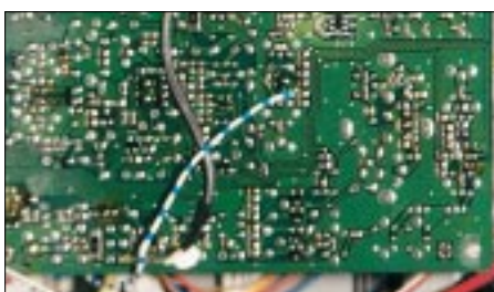
Bild 5: Anschlußpunkt C1216 auf der Unterseite der RF-Platine (gegenüber Bild 4 um 90° gedreht)
