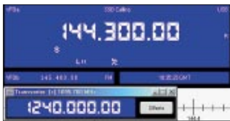
Bild 4: Das Transverter-Display stellt die tatsächliche Arbeitsfrequenz dar.
