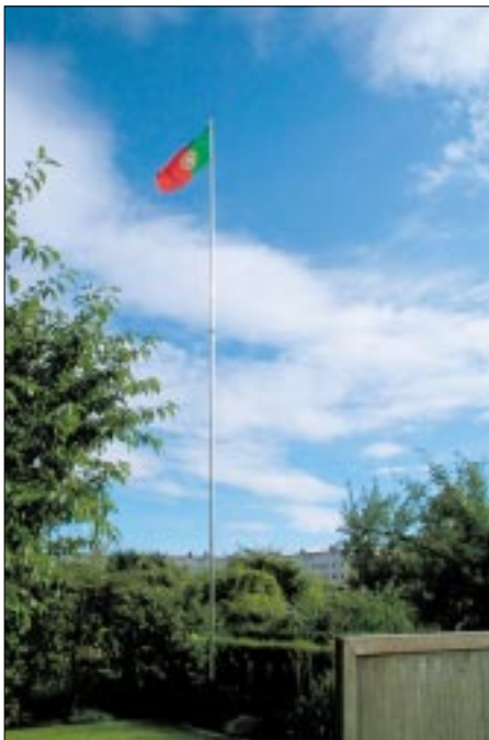
Bild 1: Fahnenmastantenne in Aktion – dank Matchbox funkt sie von 10 bis 40 (80) m.
