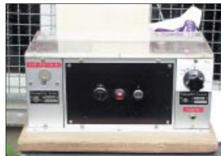
Der erste LF-Sender von Uli, DJ9IE, steht hier zum Verkauf; es handelt sich um ein umgebautes Löschgerät für Tonbänder der ehemaligen Klangfilm GmbH und liefert 10 W HF. Foto: DF2AO
